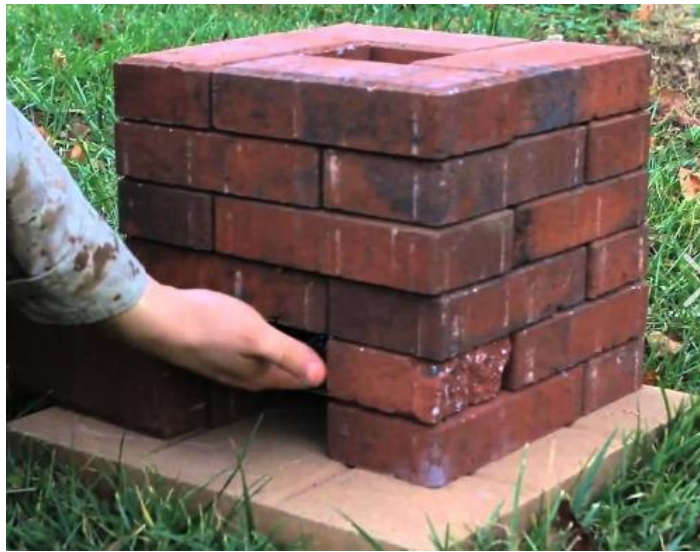
Tipico esempio realizzato con 23 mattoni. (Stoves: Brick Rocket Stove. Blogspot.com)
